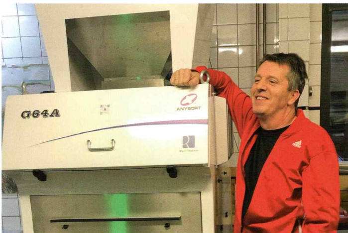
Abb. 2: Der Sortierer G64 für kleinere Produktmengen bringt Sicherheit vor Ort und benötigt kaum Platz. Die Installation, Inbetriebnahme und der Service 24/7 wird hier von Norbert Grohn durchgeführt.
